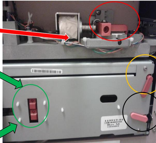
4. Si malgré cela, les cubies ne s'ouvrent toujours pas (ex : aucune alimentation électrique...), alors le cubie doit être ouvert manuellement en faisant levier sur le mécanisme.
